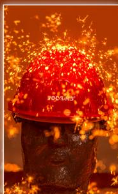
Расплавленный до 1400^{\circ}\text{C} металл выливают на корпус каски защитной
